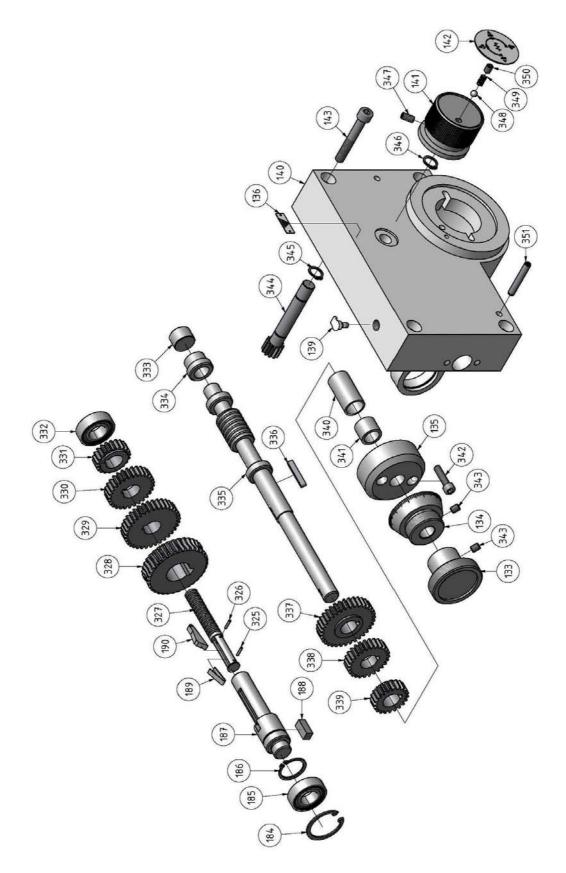
Abb.6-8: Bohrkopf 8 von 8 - Drilling head 8 von 8- B40PTE
