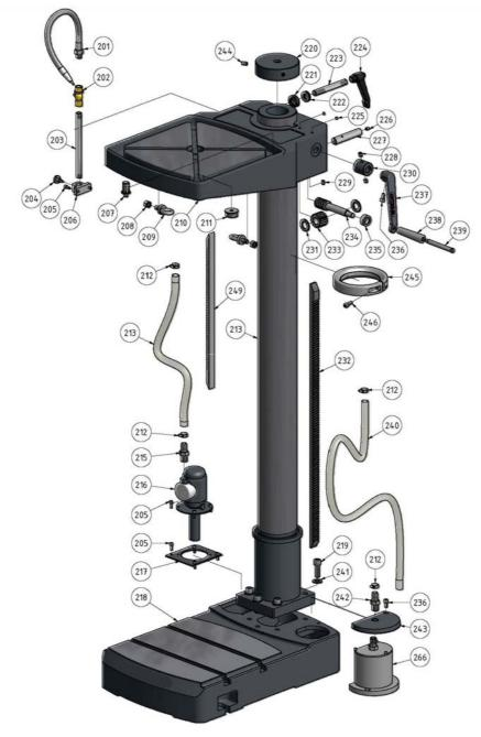
Abb.6-10: Säule und Bohrtisch - Column and drilling table B40E
